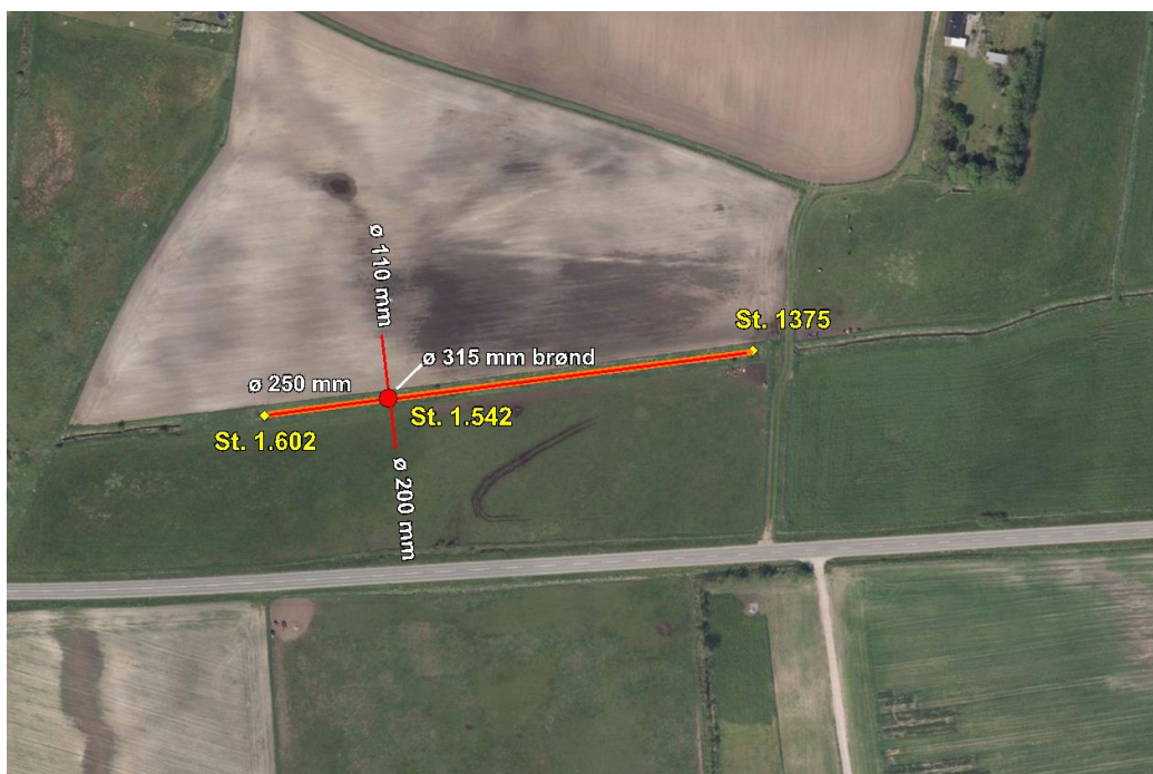
Figur 5.6.1. Oversigtskort visende eksisterende strækning st. 1.375 – 1.602 m, der skal opfyldes. Røde streger er eksisterende og planlagte dræn.
