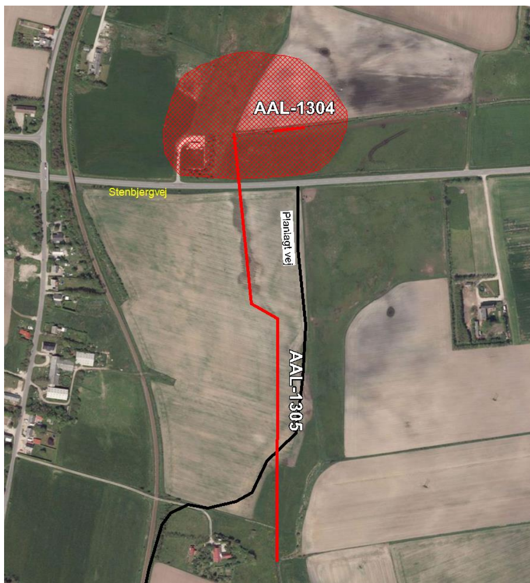
Figur 4.1. Oversigt over indsatsområdet, hvor de røde streger repræsenterer de rørlagte strækninger, mens den sorte streg er det planlagte forløb af den nye vej gennem området. Den røde skravering er et foreløbig udkast til placering af et kommende regnvandsbassin.
